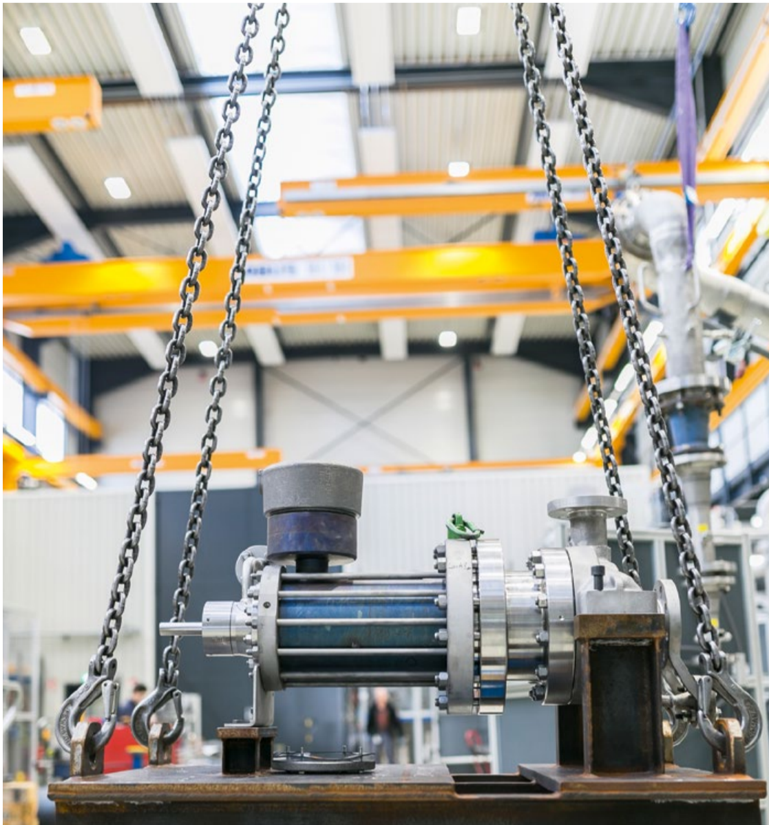
Eine Spaltrohrmotorpumpe nach API 685 zur Vorbereitung am neuen Prüfstand
